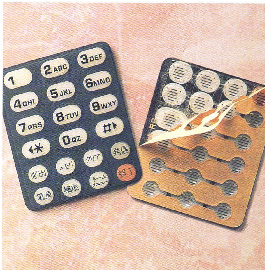
硅橡胶按键垫片之特殊用胶—使用3M™双面胶带9731硅胶面粘贴硅橡胶按键垫片, 丙烯酸胶面粘贴塑胶底部。
