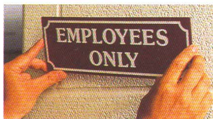
固定塑料于不平整表面—3M™ 双面 PU 海绵胶带贴合塑料指示牌于上漆碳墙。此泡沫可填补不平整表面间的缝隙。可依表面粗糙度选用不同厚度的泡沫。
