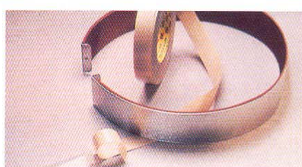
金属加热箍—3M™双面胶带9731之硅胶面粘贴硅橡胶绝缘胶片, 丙烯酸胶面则粘贴金属箍。
