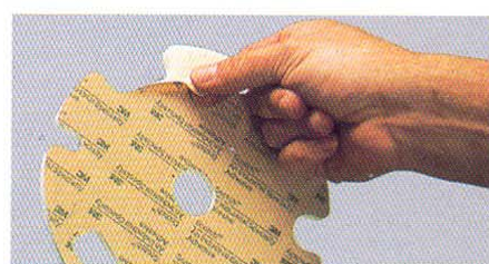
精确的冲型—预先将3M™双面胶带贴于泡绵, 再根据尺寸作全断冲切, 可增强尺寸稳定度及组装便利性。
